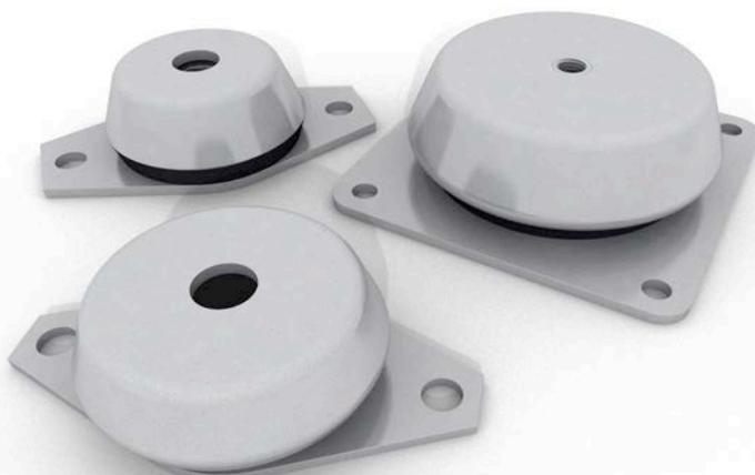
Elemento elastico in cui la gomma è vulcanizzata superiormente a una parte metallica a campana provvista di foro centrale per l'alloggiamento del bullone di ancoraggio alla macchina, e inferiormente a una base metallica di tipo simile provvista di flangia di appoggio con forature per il fissaggio.
