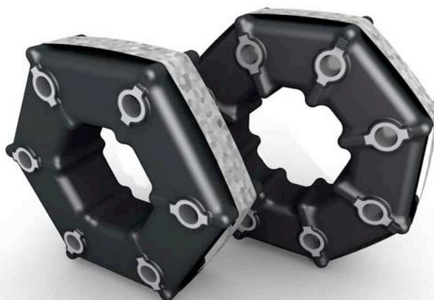
Il GIUBO è un elemento elastico costituito da tasselli di gomma disposti a formare un poligono. In ogni vertice del poligono, allo scopo di consentire il collegamento agli alberi per mezzo di crociere, sono incorporate nella gomma apposite parti metalliche con foro passante.
