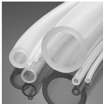
I nostri tubi per pompa peristaltica, realizzati con mescola Wacker, soddisfano i requisiti di resistenza meccanica e durata nel tempo normalmente associati al silicone perossidico. Grazie ad uno speciale processo di stabilizzazione, che ha durata di 8, 12 o 24 ore, si testa l'usura e la consistenza volumetrica migliorando la tenuta meccanica, l'elasticità e la durata. Durezza standard: 59 shore A.
