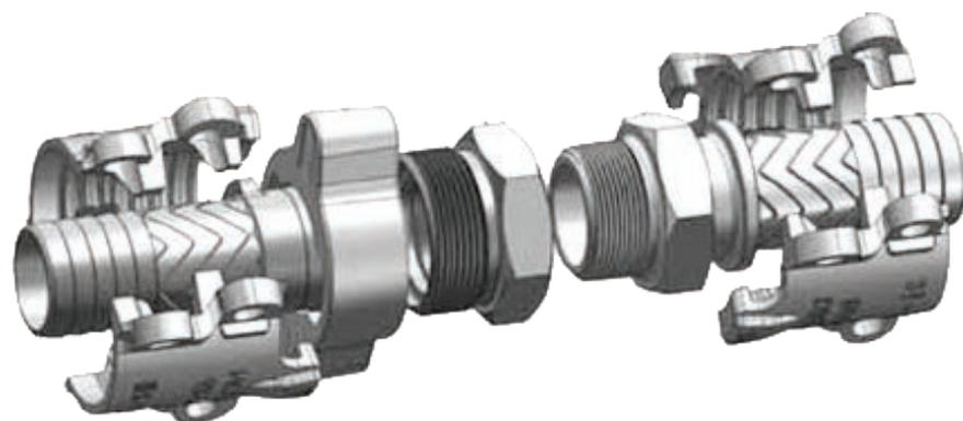
E' composto sostanzialmente da un raccordo che si innesta nel tubo con portagomma liscato la cui estremità può terminare in una filettatura NPT o BSP maschio o femmina, e un morsetto che dall'esterno del tubo, con la forza di bulloni a vite, lo avvinghia attorno al portagomma e al contempo, con due appositi rampini di presa, si aggancia al raccordo in modo da trattenerlo nonostante la pressione del vapore all'interno del tubo tenda a spingerlo via.
