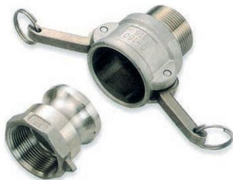
Gli attacchi rapidi CAM-LOCK sono stati studiati per ottenere nel minor tempo possibile un sicuro collegamento tra due tubazioni. Basta infatti inserire il raccordo maschio nella femmina facendo appoggiare il bordo del primo sulla guarnizione della seconda e abbassare le due leve eccentriche per ottenere il bloccaggio del raccordo.
