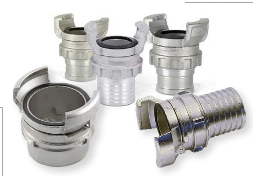
Da tale attività nasce lo standard per l'accoppiamento simmetrico Guillemín (norma NF E 29572) chiamato anche accoppiamento antincendio AFNOR, ma ampiamente utilizzato anche per l'aspirazione ed il trasferimento di prodotti in industrie chimiche, industrie agricole e per l'irrigazione con pressioni fino a 16 atm.
