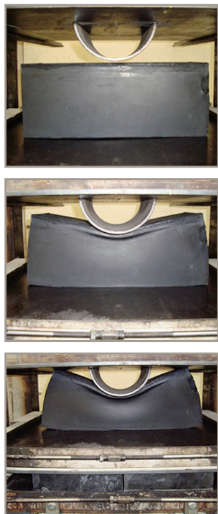
Dimostrazione della maggior rigidità dei Parabordi COMPOSITI
