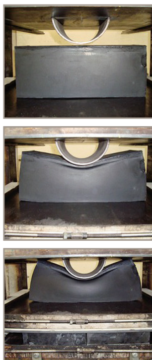
Dimostrazione della maggior rigidità dei Parabordi COMPOSITI
